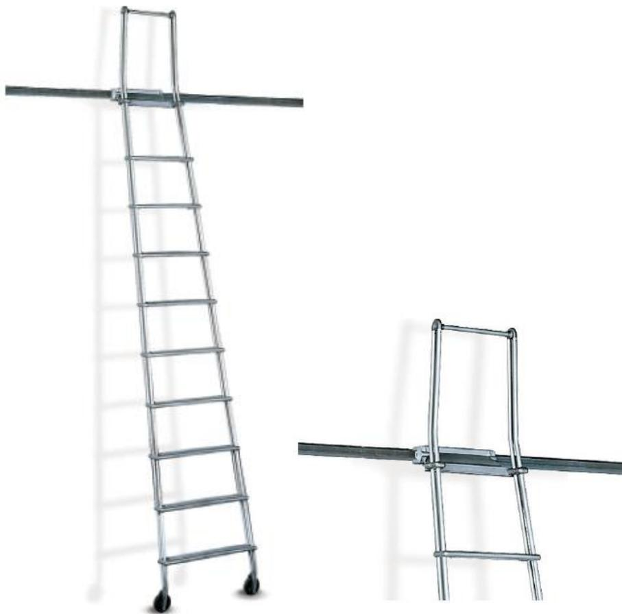
Realizzate con doppio tubo in acciaio inox AISI 441 (EN 1.4509) doppia sezione  $\varnothing$  mm.15 corredate di 2 ruote  $\varnothing$  mm.100 con boccola. Gradini antidrucciolevoli in alluminio sez.mm.85x23. I carrelli di scorrimento, corredate di 24 cuscinetti in nylon, consentono l'utilizzo delle scale in modo agevole, silenzioso e continuo nelle curve. Le scale scorrono solo in posizione di riposo con distanza da scaffale di mm.270.
