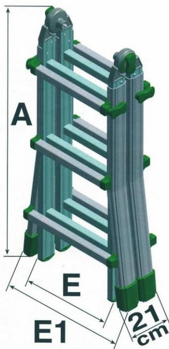
Realizzate interamente in alluminio anodizzato con montanti sezione mm.24x60 e profilo a "C" sezione mm.30x69. Gradini antisdrucchiolevoli esterni saldati e interni ribordati. Cerniera di tipo automatico con 2 possibilità di uso:
