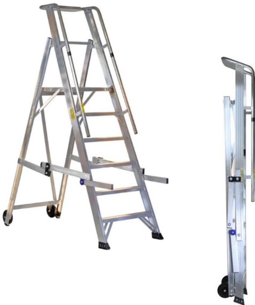
Costruite in alluminio estruso nervato, 2 ruote posteriori diam.mm.150 in pvc, gradini antisdrucciolo saldati ai montanti di mm.80 con passo da mm. 250,
