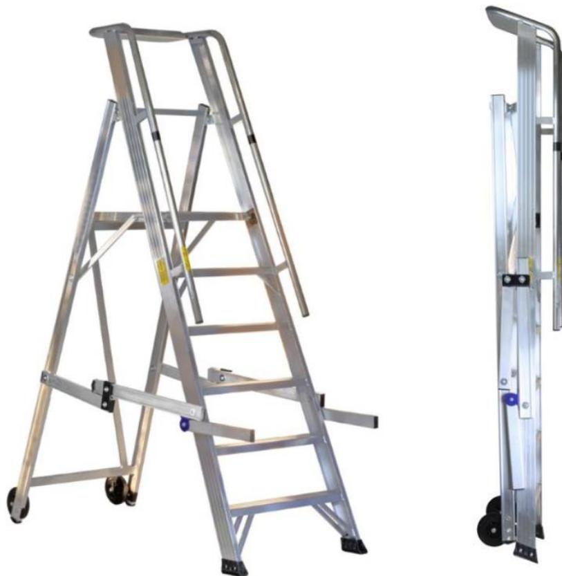
Costruite in alluminio estruso nervato, 2 ruote posteriori diam.mm.150 in pvc, gradini antidrucciolo saldati ai montanti di mm.80 con passo da mm. 250, 2 corrimano con guarda-corpo h.mm.800. Pianerottolo di mm.450 x 500, pianetto portattrezzi con portata kg.10 max.
