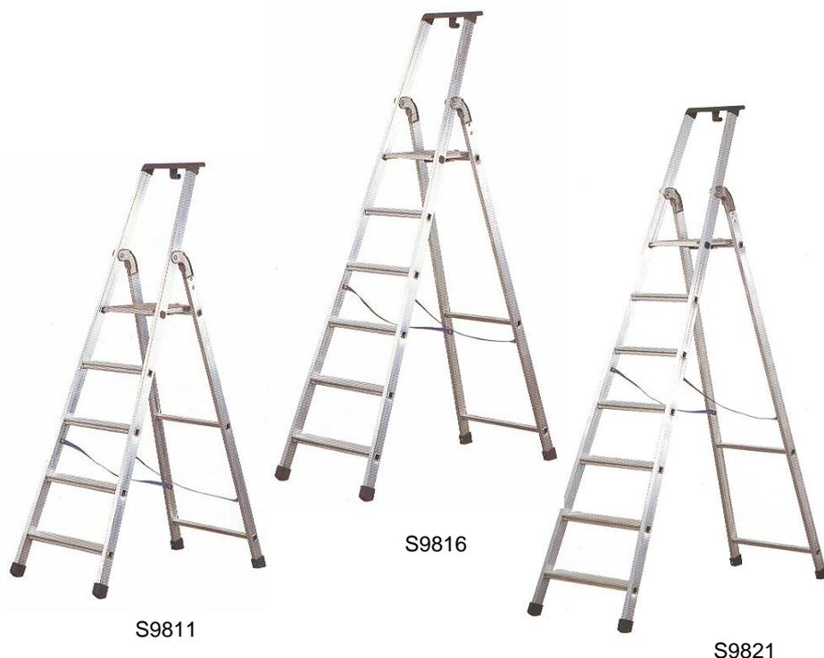
Realizzate interamente in alluminio anodizzato con montanti sezione mm.24x50. Gradini antisdrucchiolevoli sezione mm.85 bloccati direttamente ai montanti. Dotate di vaschetta porta attrezzi in plastica nera e pianerottolo autobloccante di mm.260x270 di profondità. Le scale da 5 a 8 gradini sono dotate di 2 nastri di tenuta.
