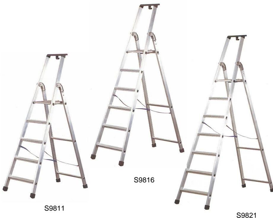
Realizzate interamente in alluminio anodizzato con montanti sezione mm.24x50. Gradini antisdrucchiolevoli sezione mm.85 bloccati direttamente ai montanti. Dotate di vaschetta porta attrezzi in plastica nera e pianerottolo autobloccante di mm.260x270 di profondità. Le scale da 5 a 8 gradini sono dotate di 2 nastri di tenuta.
