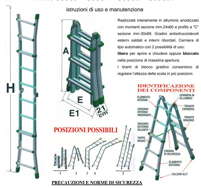
Prima dell'utilizzo delle scale accertarsi che non vi siano elementi danneggiati, flessioni di montanti e gradini, che dadi,viti e rivetti non siano allentati, i tappi antisdrucciolo siano integri e l'inclinazione sia corretta con i gradini paralleli al suolo.
