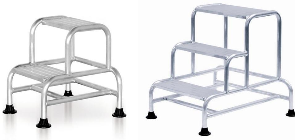
Strutture fisse realizzate interamente in tubo di alluminio saldato Ø mm. 30 x 2 sp. Gradini in alluminio di mm.200 x 22.
