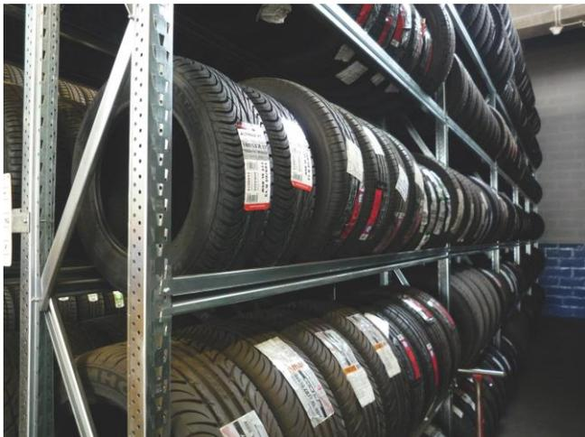
La profondità di mm.500 è idonea allo stoccaggio di pneumatici interamente realizzata in lamiera di acciaio di prima scelta certificata e profilata con macchine e attrezzature completamente automatiche.
