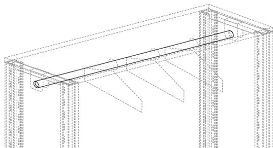
**PORTAGRUCCE** in tubo  $\varnothing$  mm. 21. Ogni campata deve avere minimo 1 piano a terra, 1 centrale e 1 di sommità per la stabilità della struttura. I traversini di sommità sostengono sia i supporti del tubo portagruccie che il piano, utilizzando gli stessi ganci. Nel caso in cui si voglia posizionare un portagruccie centrale occorre acquistare 2 traversini supplementari e 1 piano con ganci.
