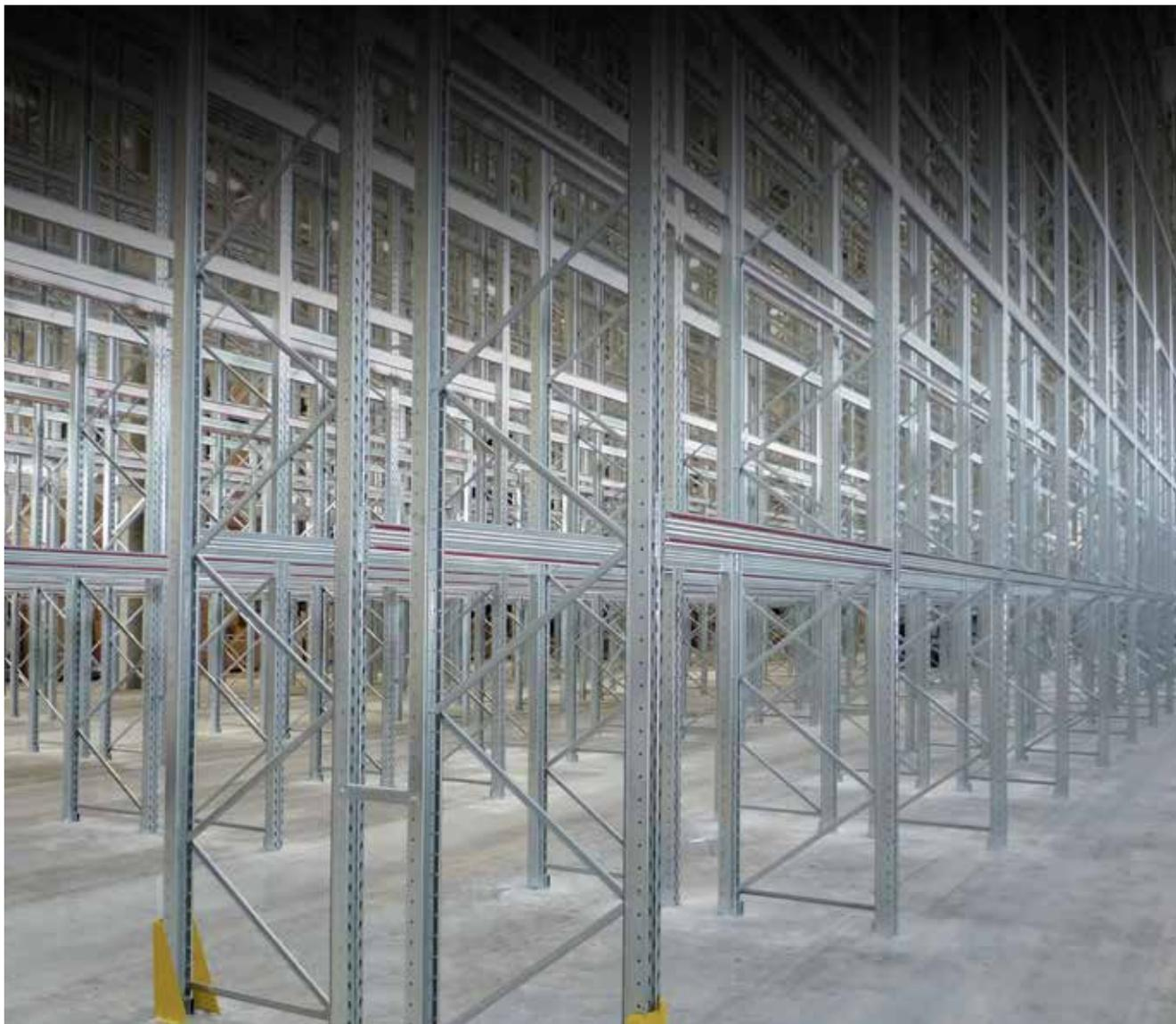
Scaffalatura interamente realizzata in lamiera di acciaio di prima scelta certificata e profilata a freddo con acciaio zincato a caldo secondo procedimento SENDZIMIR (ad eccezione delle basette che sono protette con zincatura elettrolitica). La progettazione e la costruzione sono state effettuate secondo norme UNI e hanno superato i collaudi al massimo livello. Disponibile in due versioni di diverse portate.
