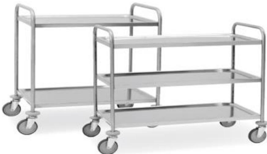
Costruiti in acciaio inox austenitico di prima scelta AISI 201 con piani stampati a vassoio. Telaio in tubo  $\varnothing$  mm.25 con 4 ruote girevoli a codolo, di cui 2 frenanti,  $\varnothing$  mm.100 in gomma termoplastica grigio scuro e nucleo in polimero grigio chiaro. Portata kg.80 ogni carrello. **Non** idonei per il contatto diretto con alimenti.
